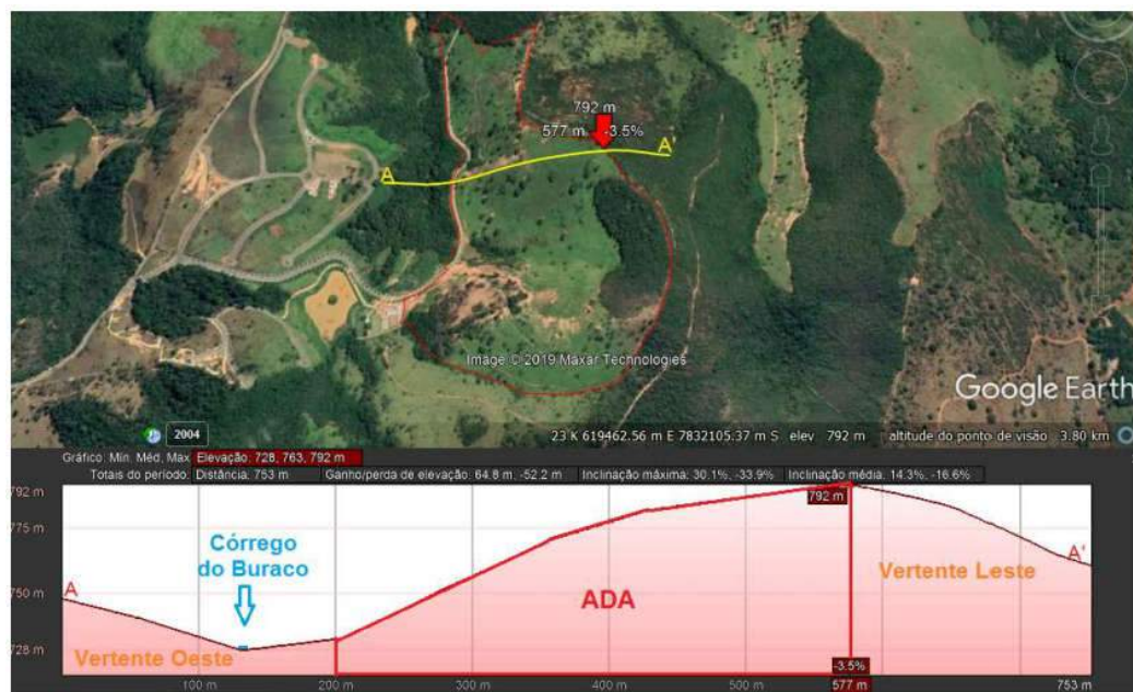
Figura 19 – Perfil esquemático da ADA, corte A-A', demonstrando direcionamento das águas pluviais para a vertente oeste. Fonte: Documentos apresentados pelo empreendedor (adaptado) – Proc. 8001/2019.
