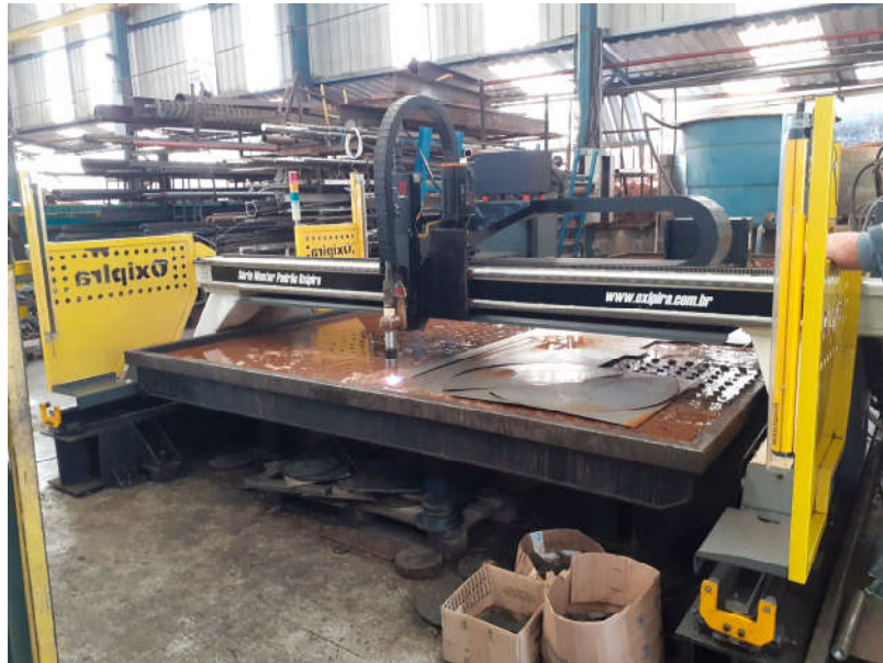
Figura 2 – Imagem da estrutura da fábrica. Destaque para equipamento de corte que consome água para o processo produtivo. Fonte: Arquivo DMA
