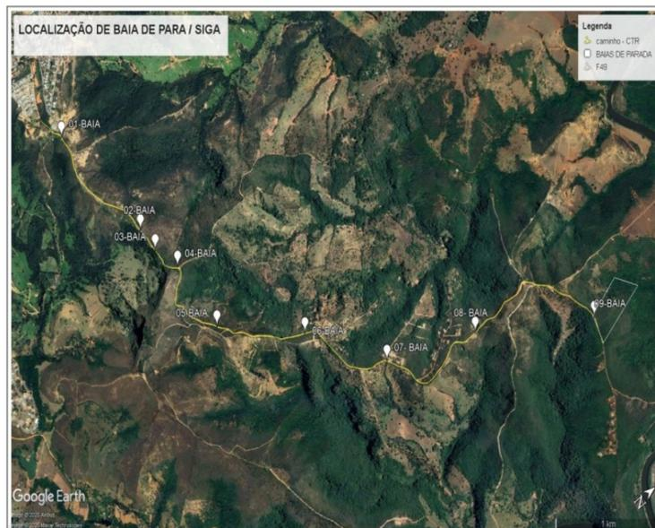
**Figura 04** – Proposta de melhoramento viário, pontos para instalação de baias PARE/SIGA. Fonte: Processo 1721-25-LST-LIC
